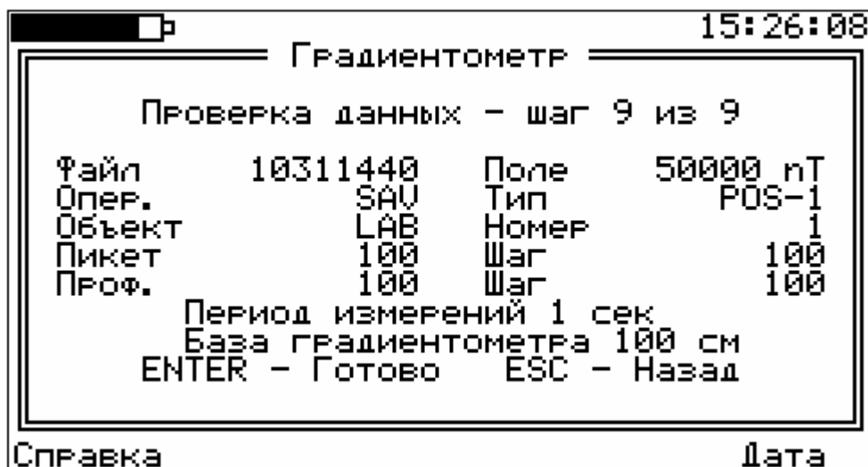
Рис. 31. Проверка параметров съемки в режиме градиентометра.
