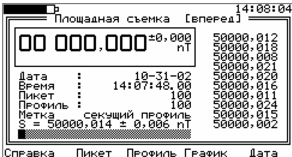
Рис. 28. Выбор метки измерения в режиме площадной съемки.
