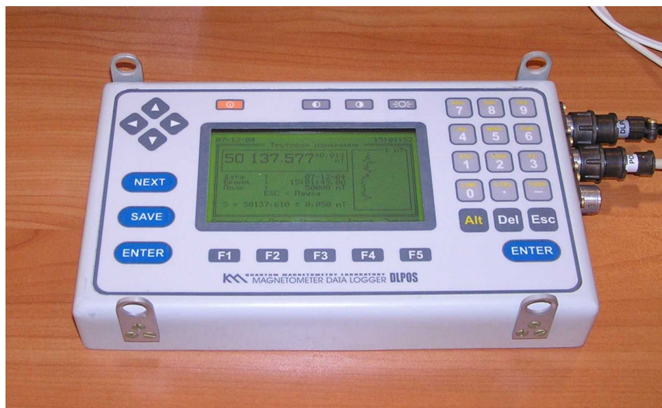
Рис. 1. Внешний вид накопителя данных DLPOS.
