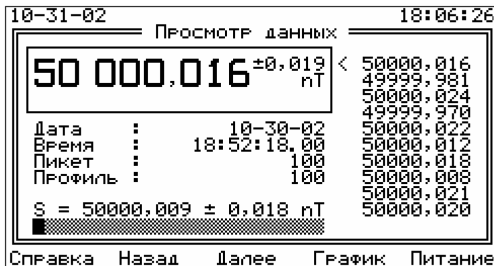
Рис. 37. Просмотр данных площадной съемки в рабочем окне режима.
