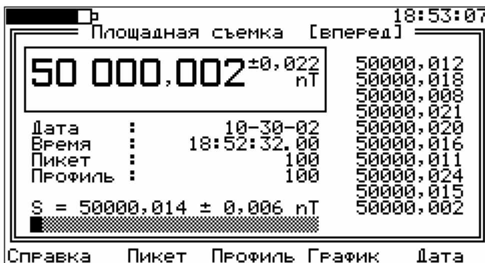
Рис. 27. Рабочее окно режима площадной съемки.
