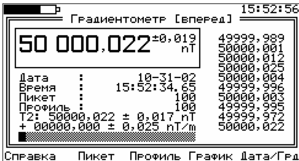
Рис. 33. Рабочее окно режима градиентометра.
