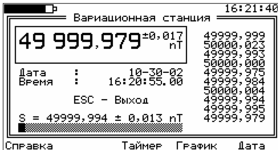
Рис. 22. Рабочее окно режима вариационной станции.
