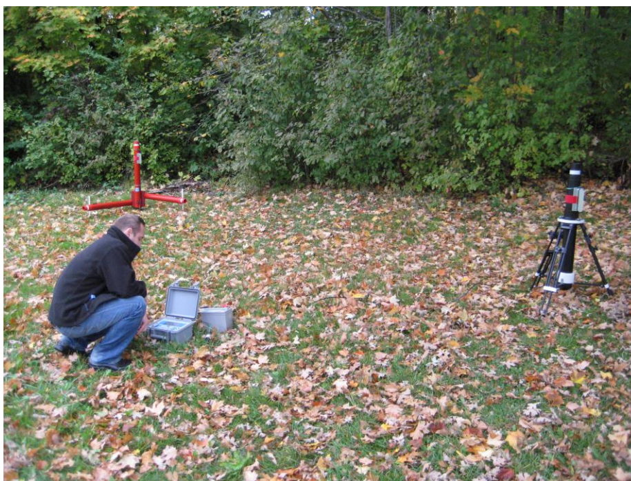
Рис. 5. Применение многофункциональной ЭМ системы при полевых работах методом МВП.
