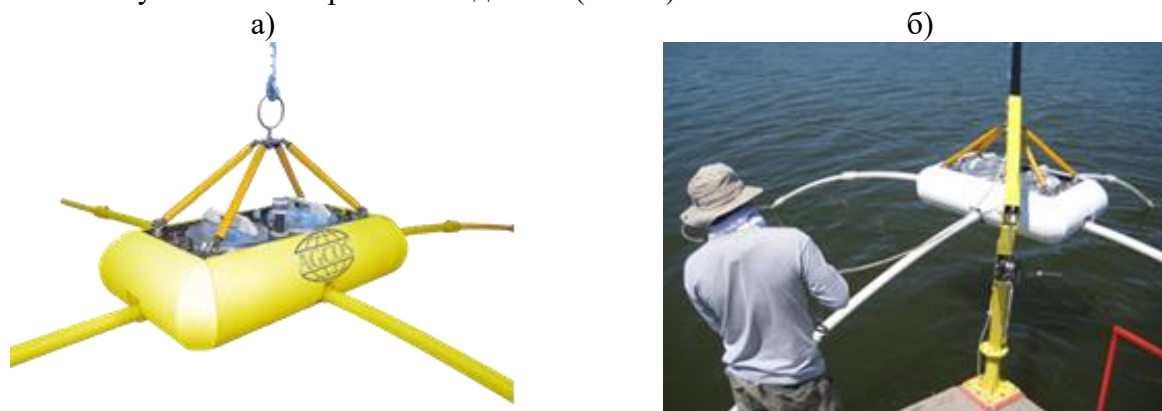
Рис. 2. Морские донные ЭМ станции для работ в транзитных зонах; (а) 2-х канальная система SMMT; (б) Запуск системы SMMT с палубы катамарана.
