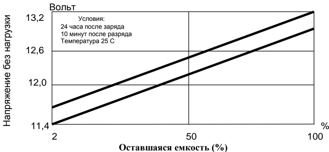
Рисунок 7 – Зависимость напряжения от оставшейся емкости
