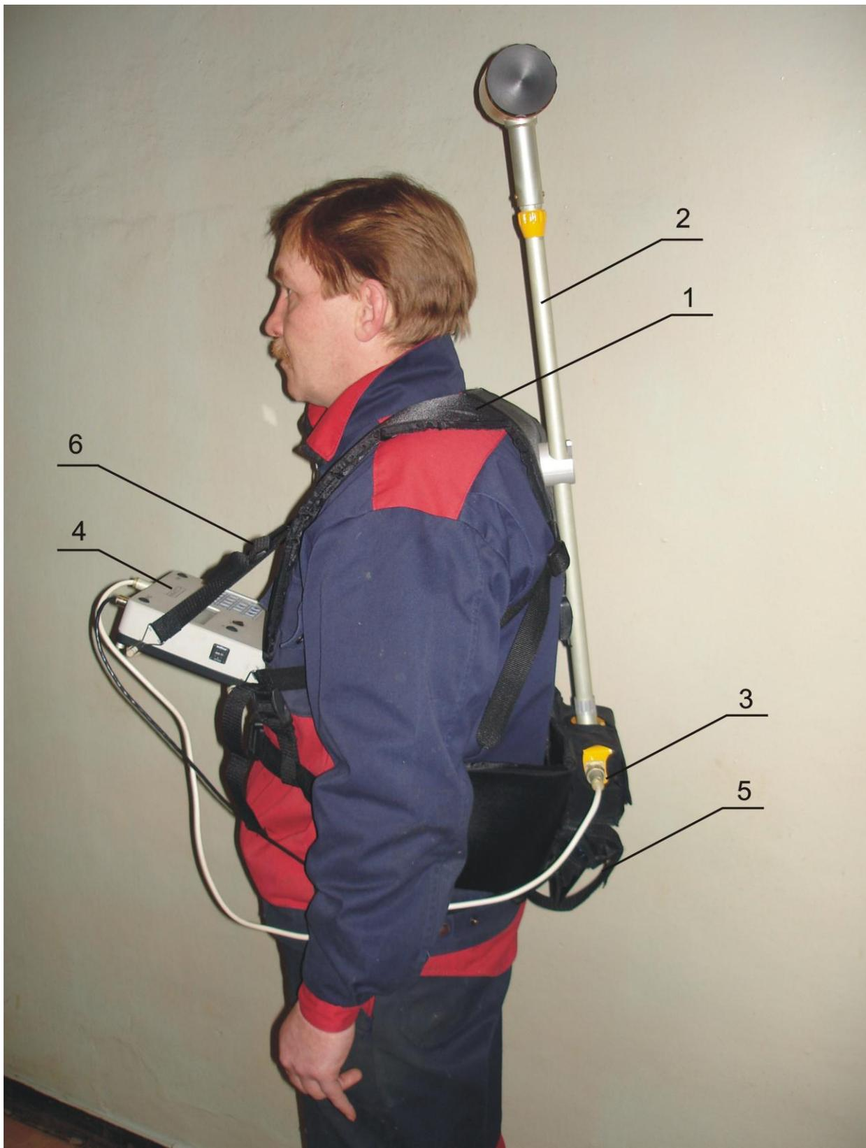
Рисунок 5 – Ранцевая подвеска магнитометра ММПГ-1
