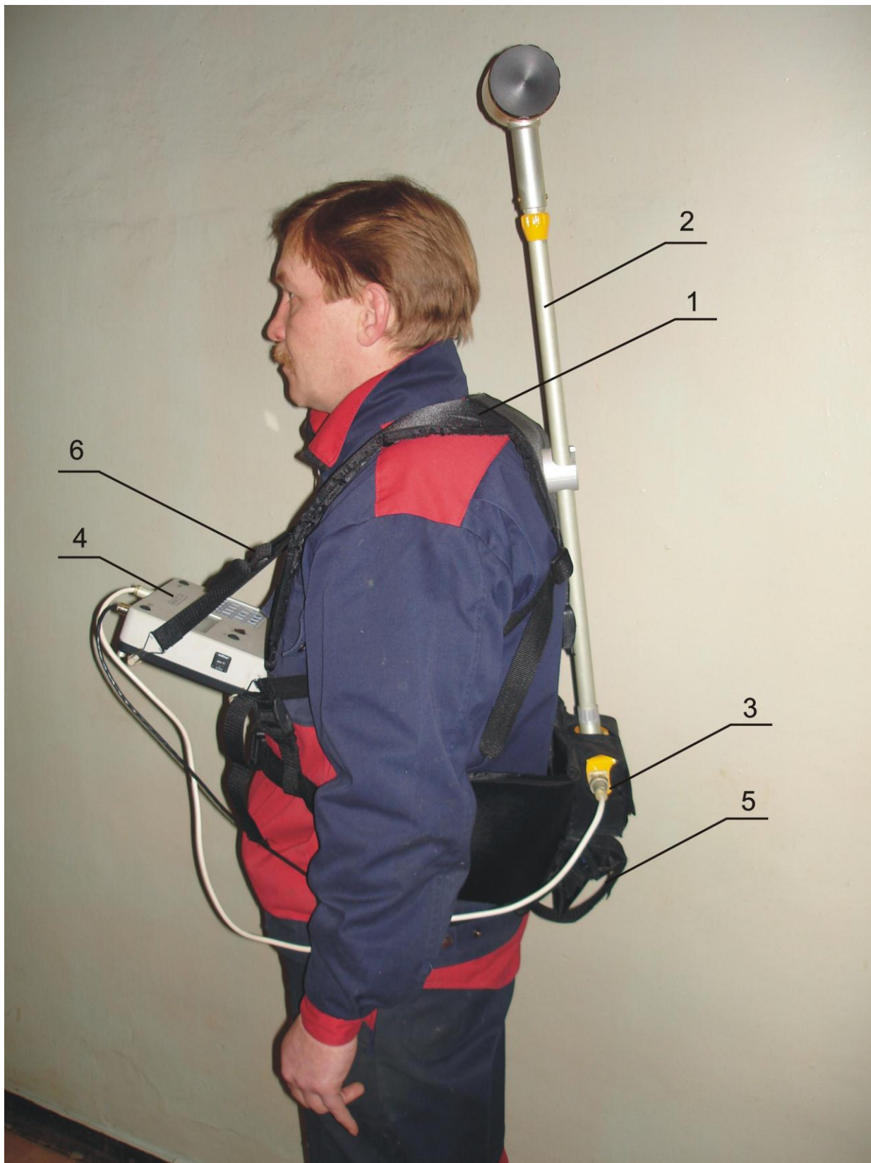
Рисунок 5 – Ранцевая подвеска магнитометра ММПГ-1 1 - заплечный станок; 2 –; МИП 3 – подключение кабеля БИР-МИП; 4 – БИР; 5 – под- сумок для установки аккумулятора; 6 – оттяжки для крепления БИР.
