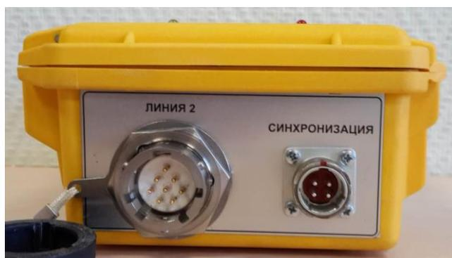
Рис. 7. Расположение разъемов для подключения телеметрической косы (линия 2) и синхронизации на интерфейсе USB.
