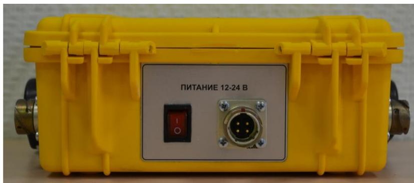
Рис. 2. Расположение разъема для подключения питания на интерфейсе USB.
