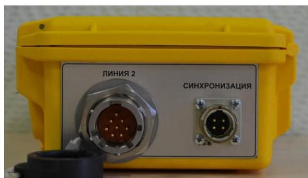
Рис. 4. Расположение разъемов для подключения телеметрической косы (линия 2) и синхронизации на интерфейсе USB.
