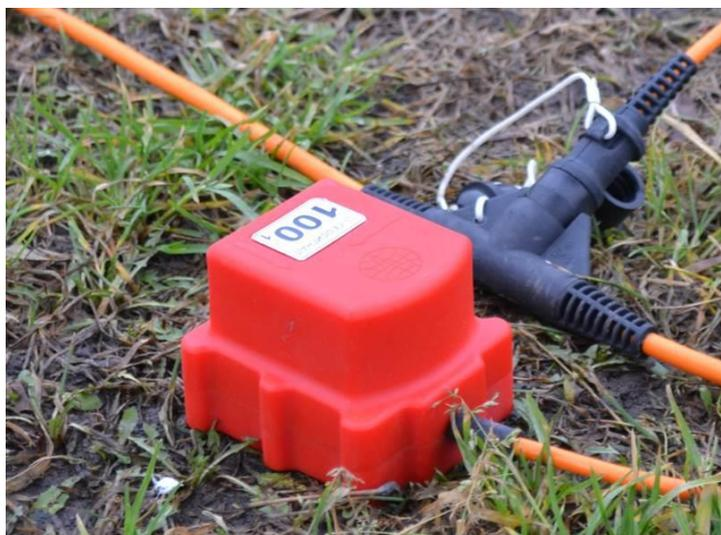
Рис. 1. Полевой модуль телеметрической сейсморазведочной системы ТЕЛСС-403.
