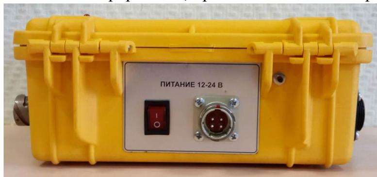
Рис. 5. Расположение разъема для подключения питания на интерфейсе ETHERNET.
