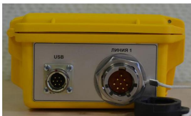
Рис. 3. Расположение разъемов для подключения телеметрической косы (линия 1) и USB порта компьютера на интерфейсе USB.
